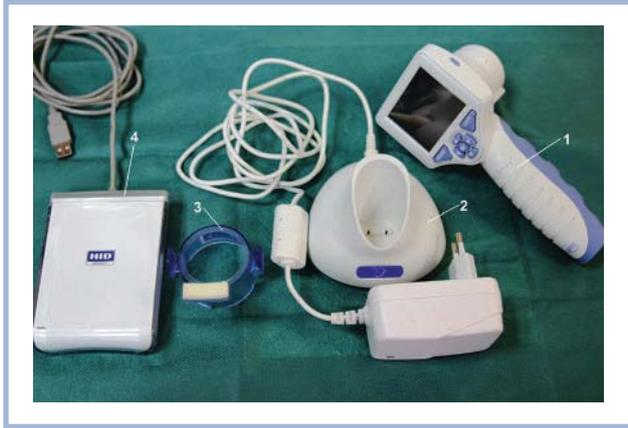
Рис. 1. Общий вид пупиллометра.
